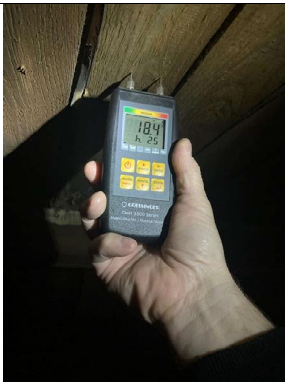
Obrázek 18: Maximální naměřená hodnota vlhkosti konstrukce
