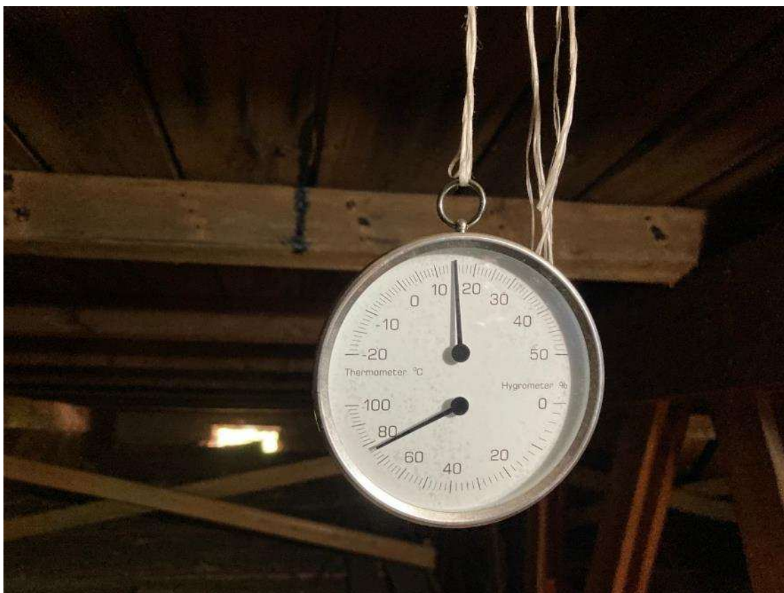
Obrázek 11: Instalovaný teploměr s vlhkoměrem – 79% vlhkosti při teplotě při 15°C ze dne 4.11.2024
