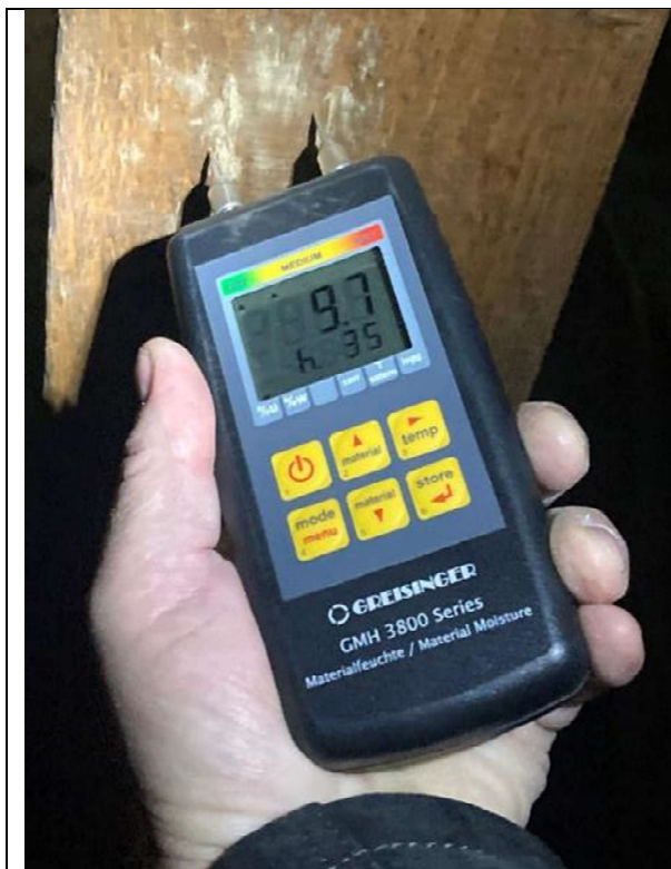
Obrázek 17: Minimální naměřená vlhkost konstrukce
