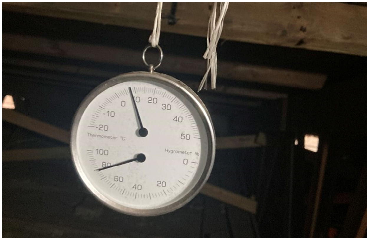
Obrázek 15: Měření vlhkosti ke dni 19.11.2024, teplota 8°C, vlhkost vzduchu 80%
