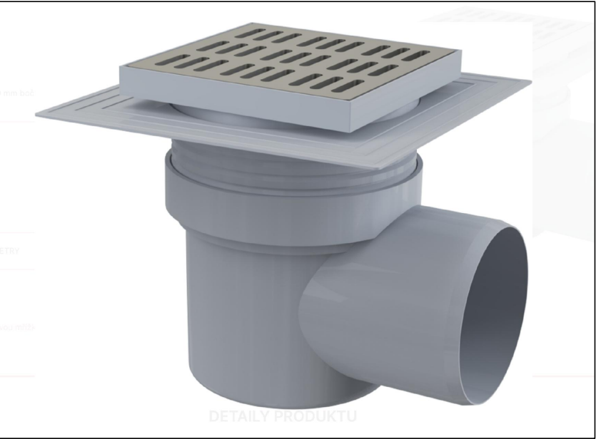
2 x APV12 Podlahová vpust 150x150/110 mm boční, mřížka nerez, límec 2. úrovně izolace, vodní zápachová uzávěra
